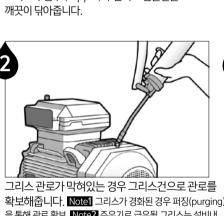
본체 안에 배터리 팩을 삽입합니다. 확보해줍니다. Note1 그리스가 경화된 경우 퍼징(purging) 을 통해 관로 확보. Note2 주유기로 급유될 그리스는 설비내 그리스(기존 그리스)와 동종 또는 호환성이 있어야 함
