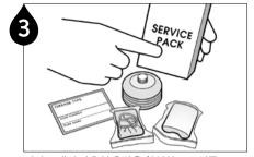
서비스 팩의 파우치 용량을 확인하고 구성품 (배터리 팩, 파우치, 더스트 커버, 메모라벨)을 확인합니다.
